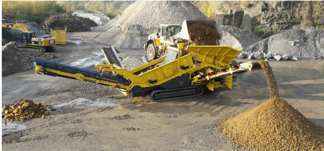
Figure 5-8 : Exemple de séparateur granulométrique
